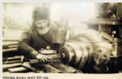
Обработка концов труб. 2010 год.
